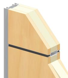
Cloison avec parement en joint creux
