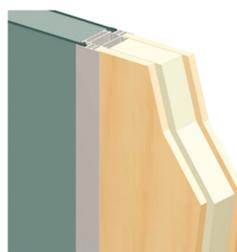
Cloison traditionnelle avec couvre-joint
